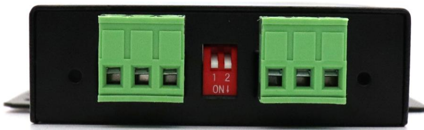
图 2.4 CAN 总线接口位置
