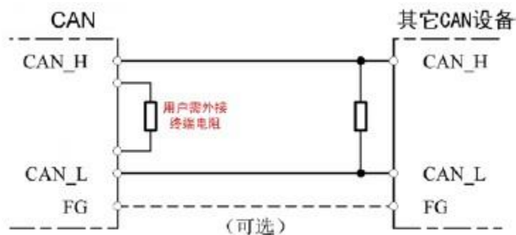
图3.5 广成科技GCAN-202与其他CAN节点设备连接
