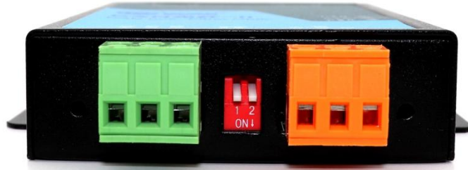
图 2.5 GCAN-208-2CAN 总线接口及电源接口位置
