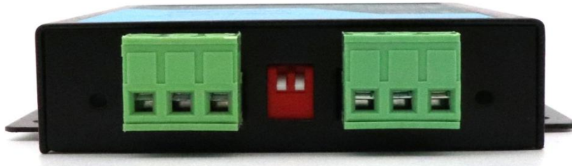
图 2.4 GCAN-208-1 模块 CAN 总线接口
