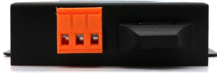
图 2.3 GCAN-208-1 电源及光纤接口位置
