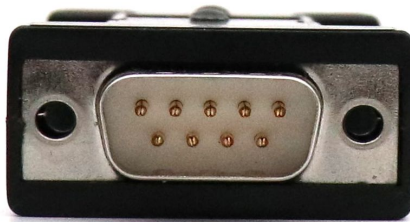
图 2.3 单线 CAN 端 DB9 接口（公头 插针）
