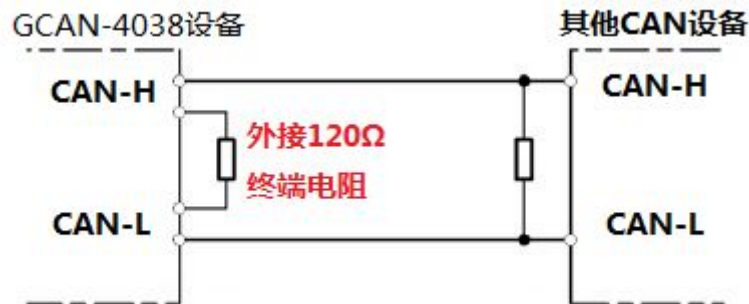
图 3.2 GCAN-4038 与其他 CAN 节点设备连接
