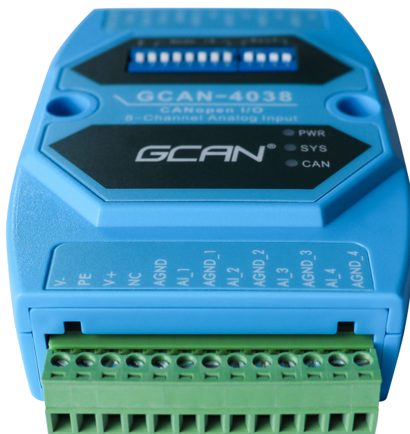
图 2.2 电源及 4 路模拟量输入接口位置
