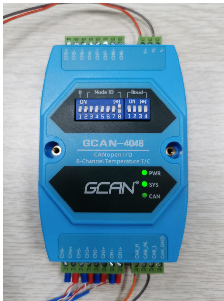
图 3.4 GCAN-4048 CAN 灯状态
