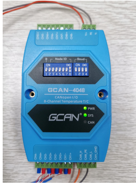
图 3.3 GCAN-4048 PWR 和 SYS 灯状态
