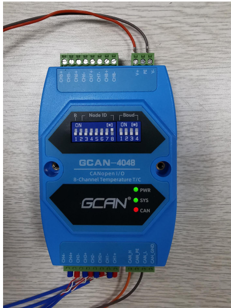
图 3.5 GCAN-4048 CAN 灯状态
