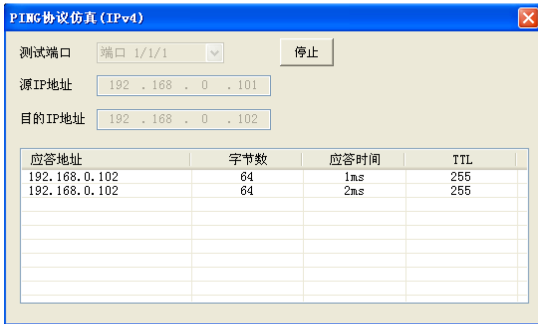
图 2-47 IPv4 PING 协议仿真测试界面
