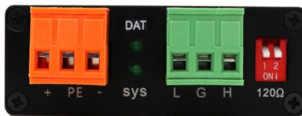
图 2.2 GCAN-401 模块电源端子接口
