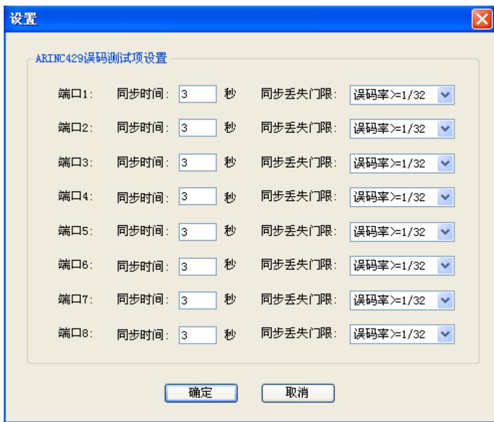
图 2-14 同步丢失门限和同步时间设置界面
