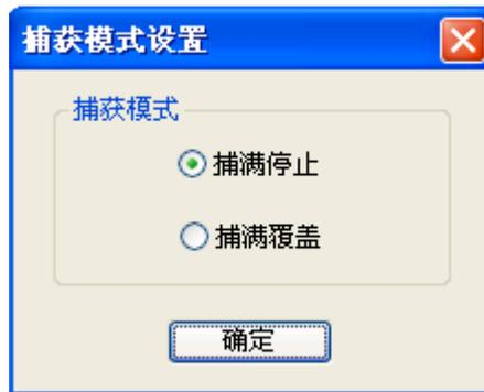
图 2-9 ARINC429 模块捕获存储深度设置界面
