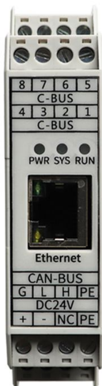
图 2.3 GCAN-GT-414 模块接线端子排
