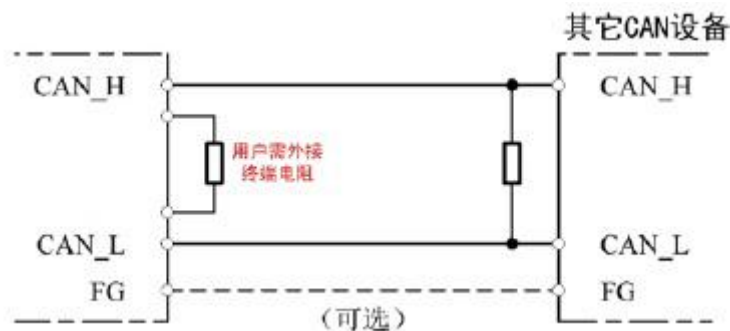
图3.5 GCAN-304模块与其他CAN节点设备连接
