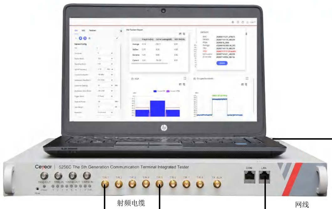
图 3.2 5256C 5G 终端综合测试仪自回环测试连接图
