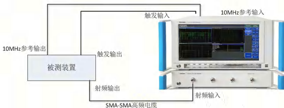
图 4.12 被测设备与基站测试仪连接图
