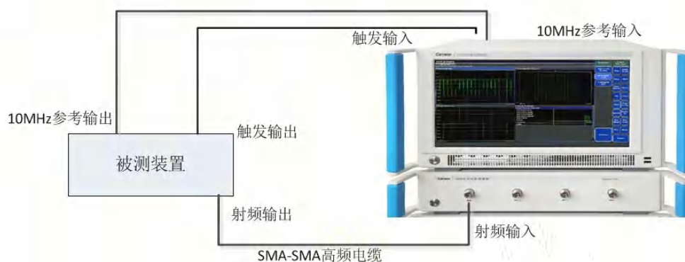
图 4.10 被测设备与基站测试仪连接图
