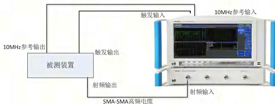
图 4.7 被测设备与基站测试仪连接图
