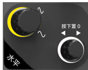
图3.20 水平系统操作区
