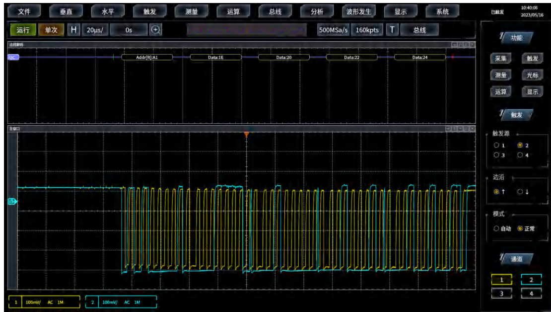
图3.149 I2C 触发与分析示例
