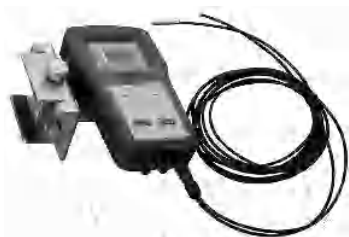
图 3.4 87110A 辐照度计固定示意图
