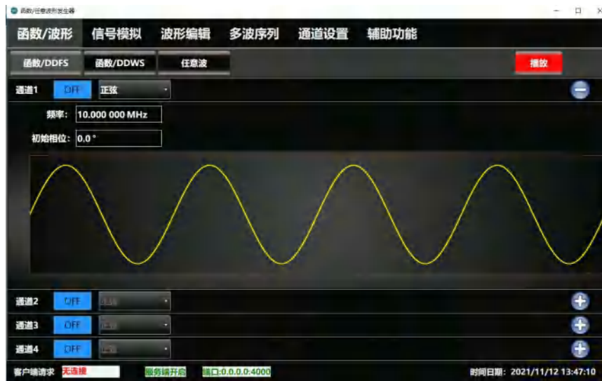
图 3.4 正弦波输出设置界面
