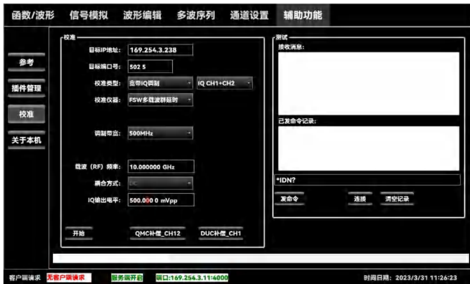
图 3.32 1652B 宽带校准界面
