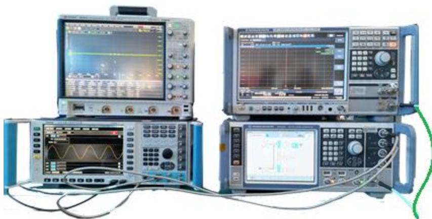
图 3.31 IQ 宽带校准接线图
