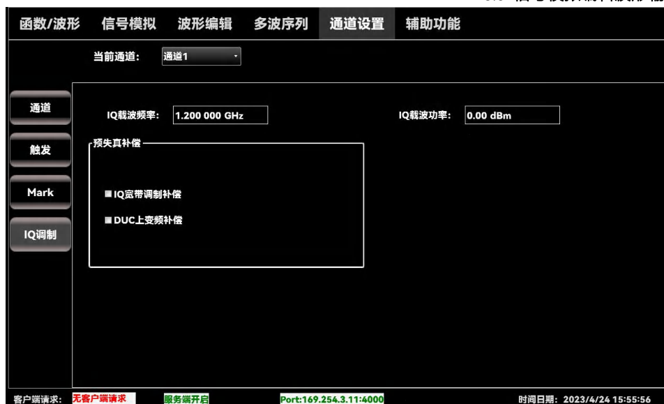
图 3.20 上变频模式输出宽带信号载波设置
