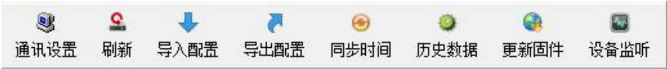
导入配置、导出配置---用于大批量设备设置，A 设备参数复制到 B 设备就可以使用此功能。
