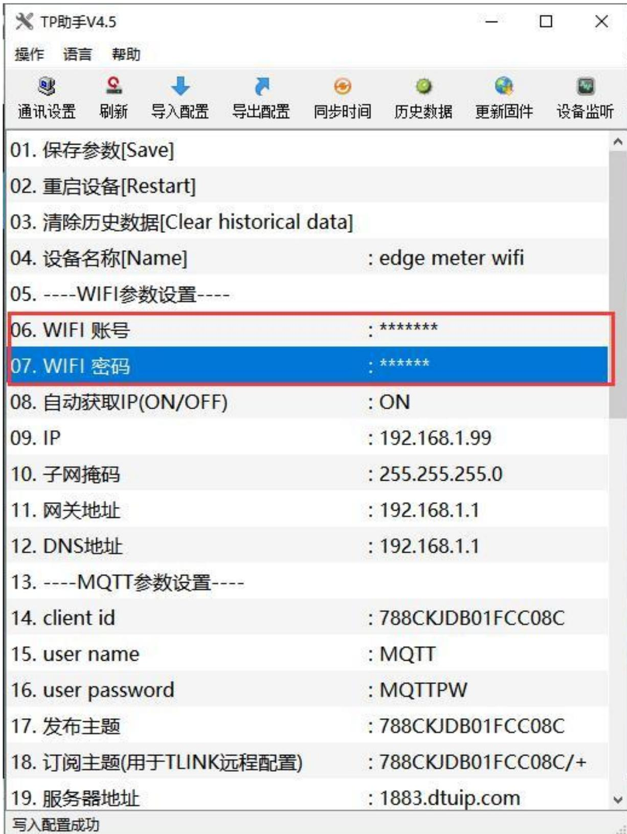
4, 在弹出的设置窗口内输入设定值回车或点击提交, 配置参数即可提交到仪表内, 配置完整后需要操作【保存配置】进行保存配置操作。
