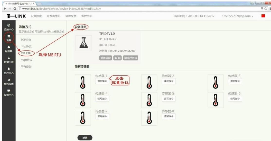
图 5.3 MB RTU 协议界面图
