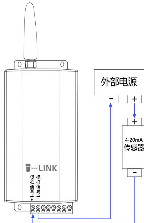
※ 注：当使用 RTU 外部供电输出端口代替外部电源给 4-20mA、0-5V 传感器供电时，
