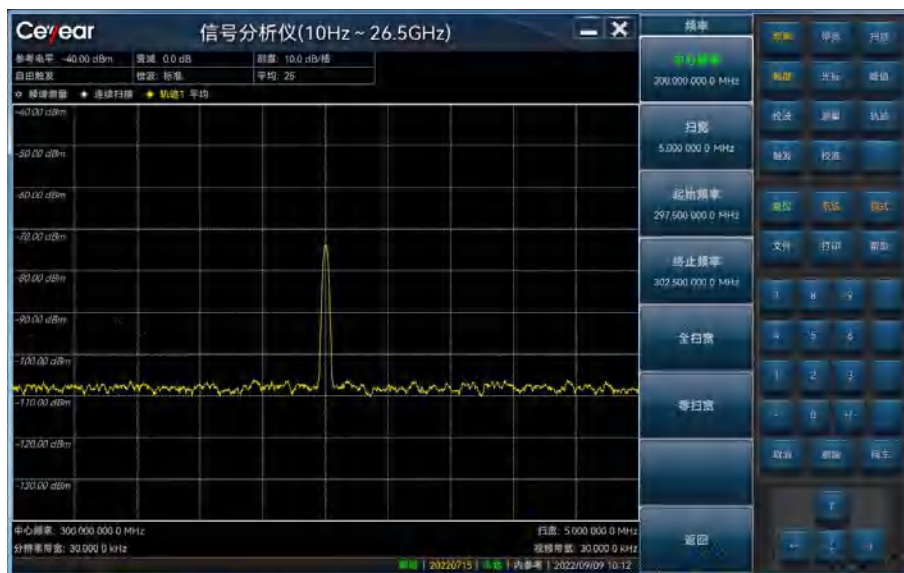
图3.21 采用轨迹平均测量小信号
