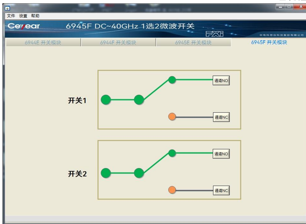
图 3.6 6945F DC ~ 40GHz 1 选 2 微波开关通断设置软件界面
