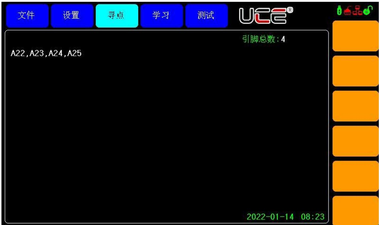
通过表笔可以探测点位，显示如图所示，显示出巡查的点位，以及巡查的引脚总数。同时当表笔探测到引脚时，会发出“嘟嘟”的提示音。
