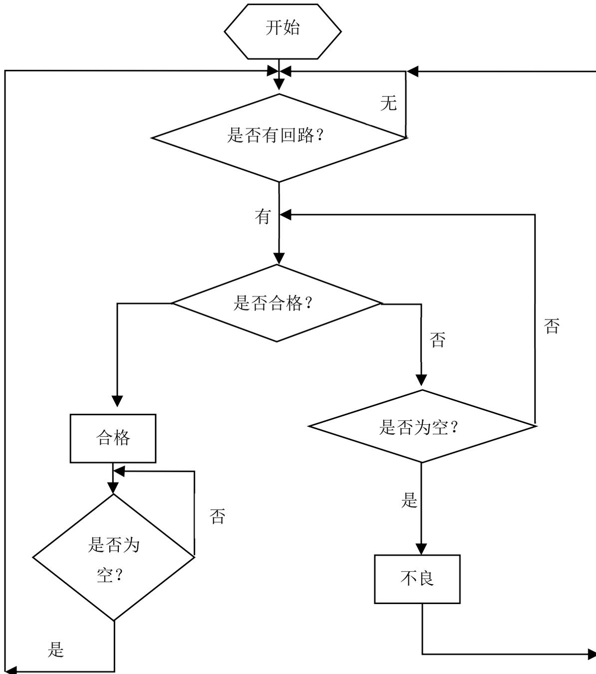
➤ 单次：在开始测试时需要检测是否按下“测试”按钮，而后再进入测试状态。
