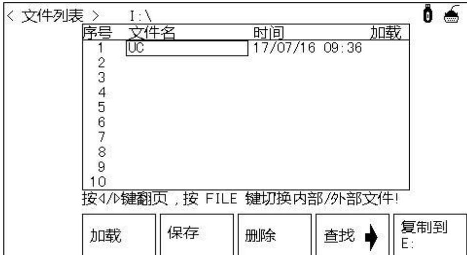
仪器可以将用户设定的参数以文件的形式存入仪器内部非易失性存储器，当下次要使用相同的设定时，用户无需重新设定这些参数，只需加载相应的文件，就可以得到上次设定的参数。从而大大地节省了用户重复设定参数的时间，提高了生产效率。
