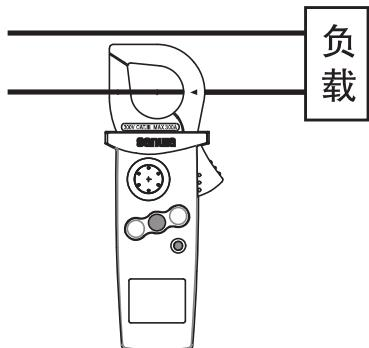
在电流探头中央夹入一根电线。
