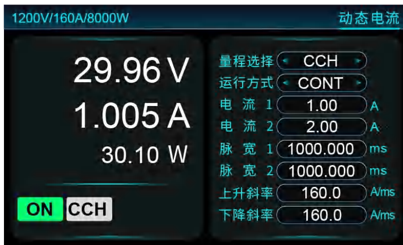
图 5-30 动态电流拉载
