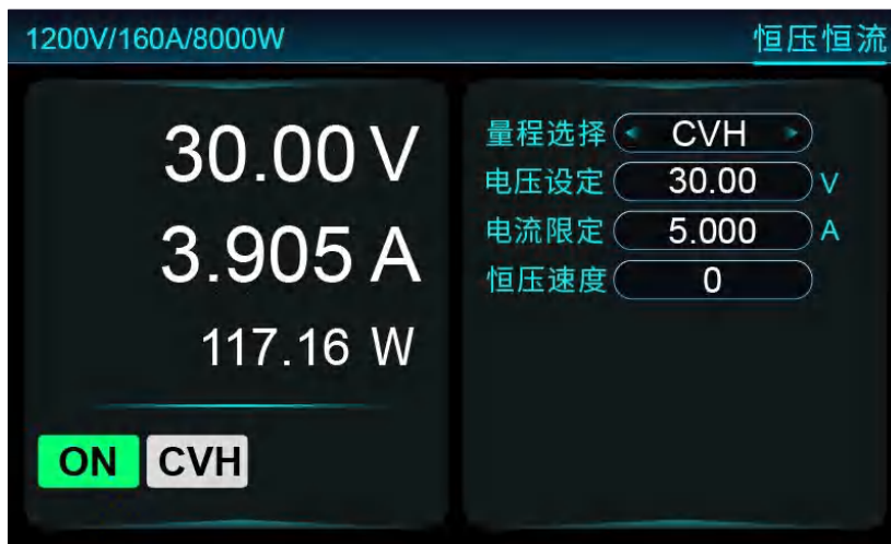
图 5-17 恒压恒流拉载
