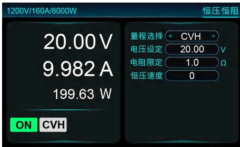
图 5-25 恒压恒阻拉载
