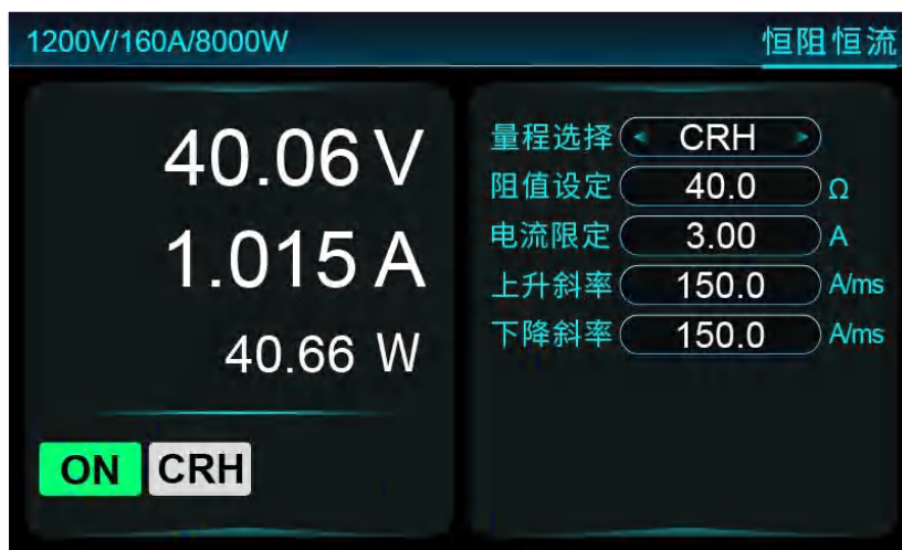
图 5-20 恒阻恒流拉载
