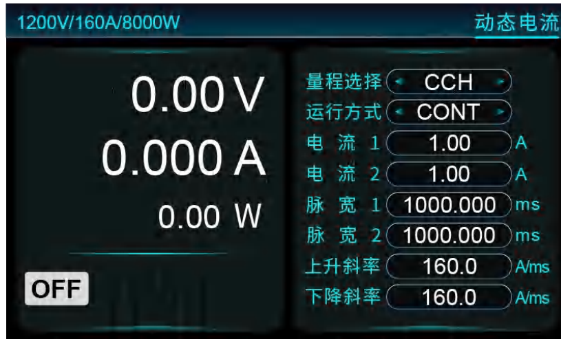
图 5-29 动态电流测试界面
