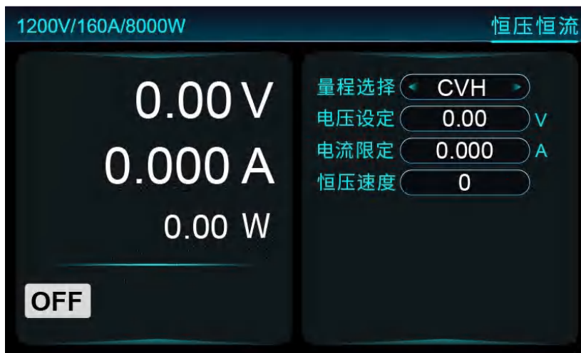
图 5-16 恒压恒流界面
