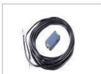
RS-232接口：RS-485/ RS-232接口转换器
