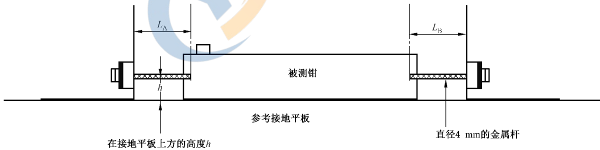
图 A.5 插入被测钳的试验夹具
