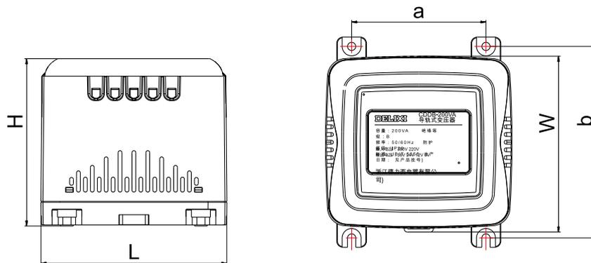
CDDB导轨式变压器外形及安装尺寸
