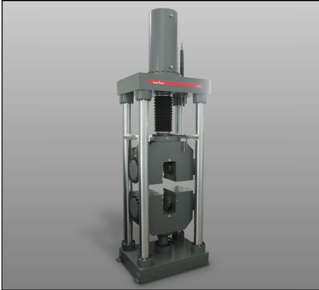
ZwickRoell Z2000H mit Hydraulik-Probenhalter
