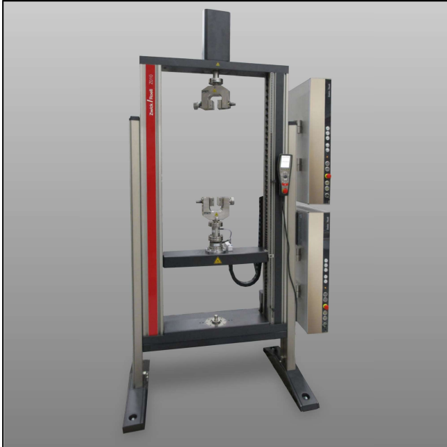
Tisch-Prüfmaschine mit Torsionsantrieb auf Kopftraverse
