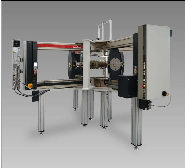
Kreuzzug-Prüfmaschine in horizontaler Anordnung
