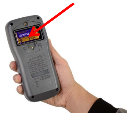
3、将9V电池装进电池仓内
