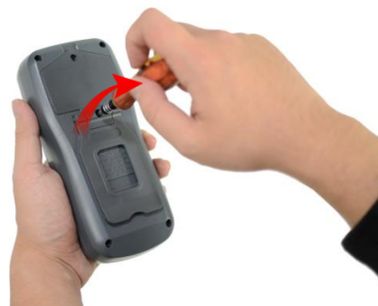
4、用十字螺丝刀拆卸，向右旋转，旋紧即可
