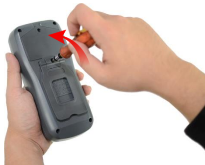
2、用十字螺丝刀拆卸，向左旋转，松开螺丝拆下电池盖
