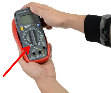
5、装上胶套，底部先套进去，再调整顶部
