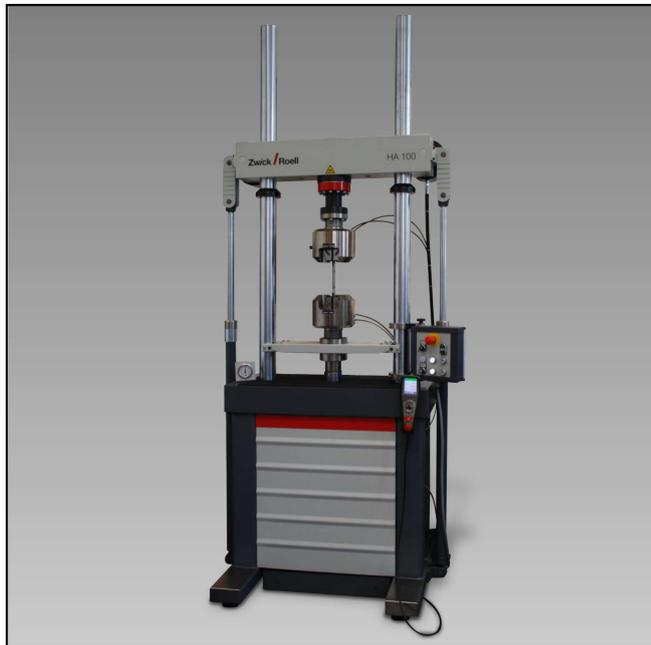
HA 100 auf Luftfedern mit hydraulischem Keilspannzeug
