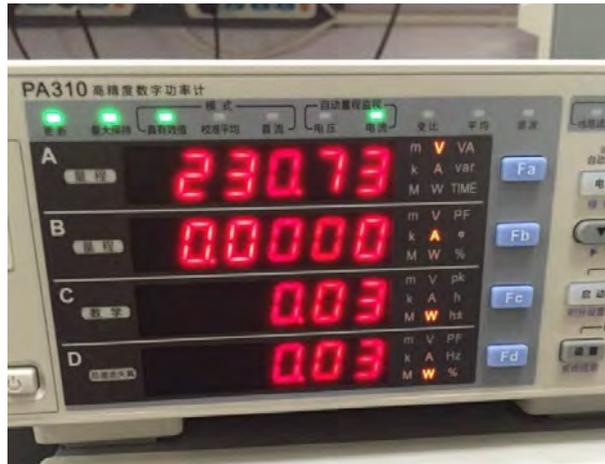
该工程师非常疑惑，于是与我司技术人员沟通测试方案，在详细了解其测试过程以及仪器参数设置之后，我司技术人员给出了测试建议，修改了部分设置参数以及测试接线方式，得到了真实的待机功耗数据，测试参数如下图所示：
