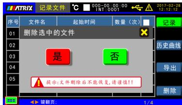
本机可以循环记录64个文件(GSV文件,可使用EXCEL直接打开),每个文件最多可以记录130000笔数据(与通道数量无关)。文件可以直接导出到U盘(只支持32G以下/FAT32),或转存到仪器内部U盘空间,使用“秒变U盘”功能(设置页面中),PC连接仪器前面板U盘接口,直接读取记录文件。
