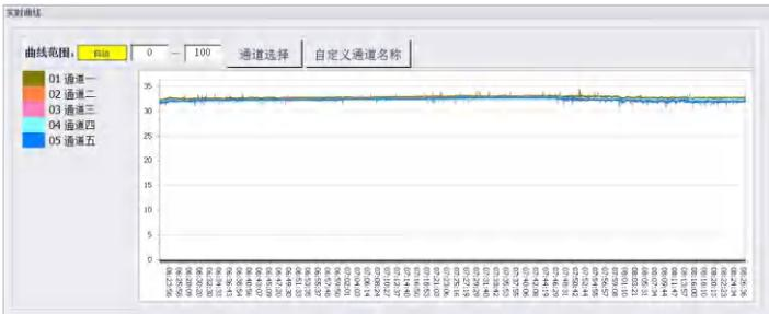
曲线标签可以对文件中的所有数据进行详细的分析，可以直使用鼠标直接对曲线进行放大缩小和左右上下平移。
