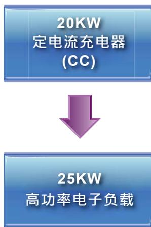
图2：单台充电器连接单台负载
