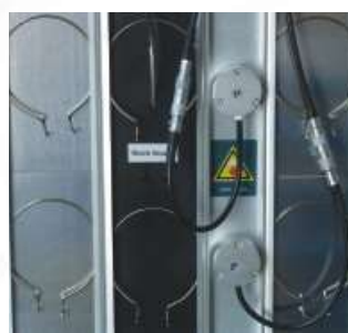
四个辐照度探头实时监控BUV的辐照度
