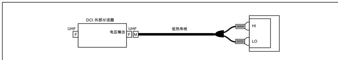
图 17.外部直流分流器连接
