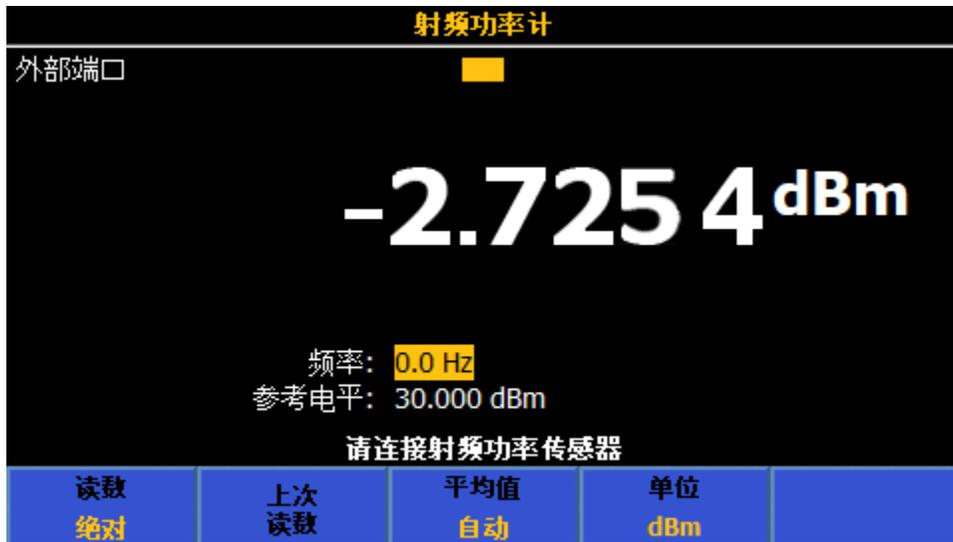
将兼容传感器插入外部端口 (EXT PORT) 时，射频功率 (RF Power) 菜单顶部会显示传感器类型和序列号。屏幕的下半部分有以下两个参数，可以使用导航键和数字键盘进行更改：
