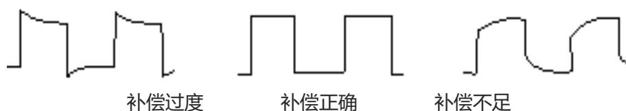
图 2 探头补偿校正
