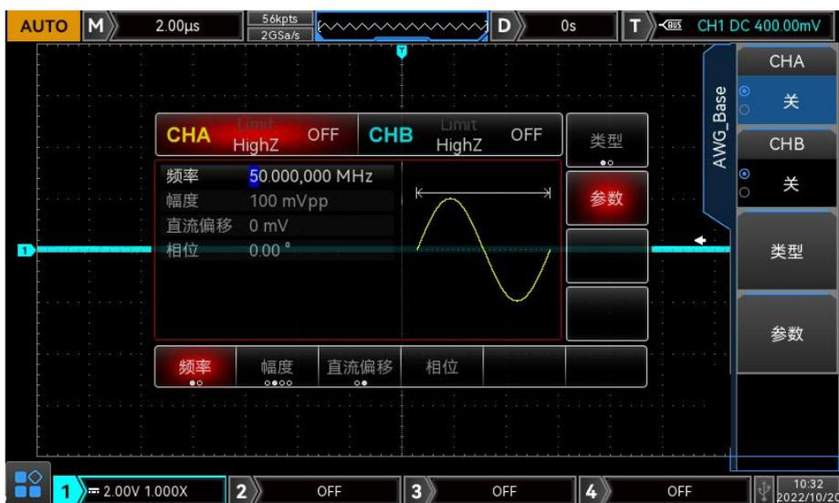
内置函数任意波形发生器，可输出正弦波、方波、斜波、脉冲波、任意波、噪声和直流。
