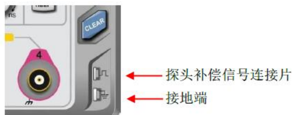
图 4-1 探头补偿信号连接片和接地端
