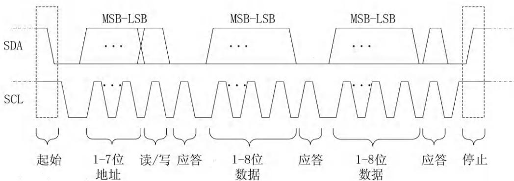
I<sup>2</sup>C 解码触发，可设置 SCL 源、SDA 源、操作方向、触发条件、地址设置、数据设置等。
