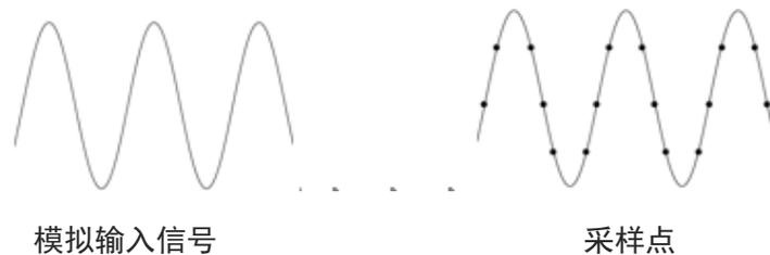
采样率指示波器两个采样点之间的时间间隔。UP01000CS 系列数字荧光示波器的最高采样率为 1 GS/s。采样率会受时基档位、存储深度变化而产生变化。UP01000CS 数字荧光示波器将采样率实时显示在屏幕上方状态栏中，可通过水平 SCALE 调节水平时基，或修改“存储深度”来改变。
