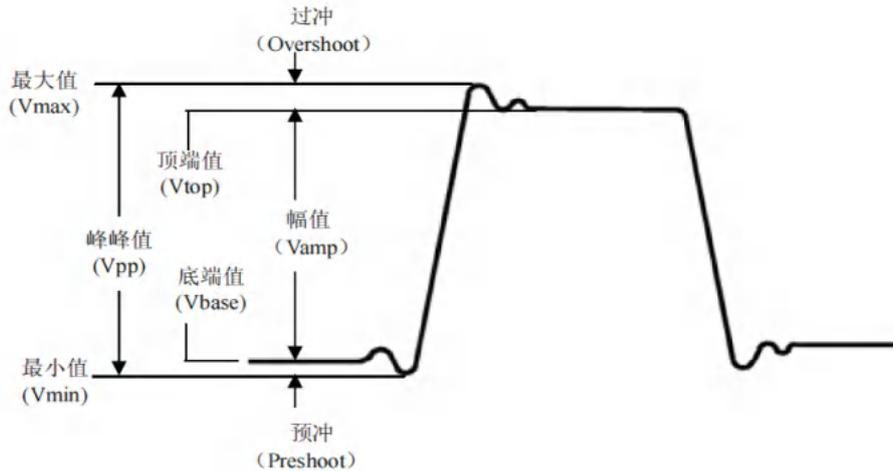
最大值 (Max)：波形最高点至 GND (地) 的电压值。
