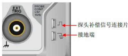
图 4-1 探头补偿信号连接片和接地端
