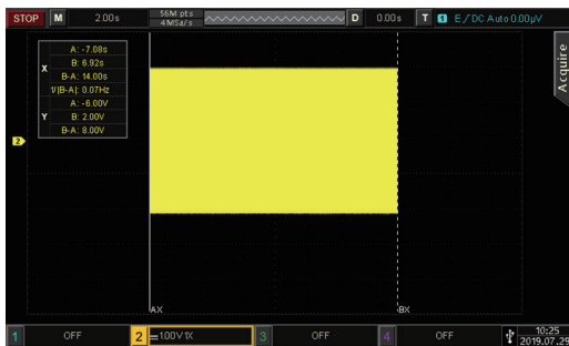
1 最高56Mpts存储深度,用户能够捕获更长时间的信号,不丢失波形细节
