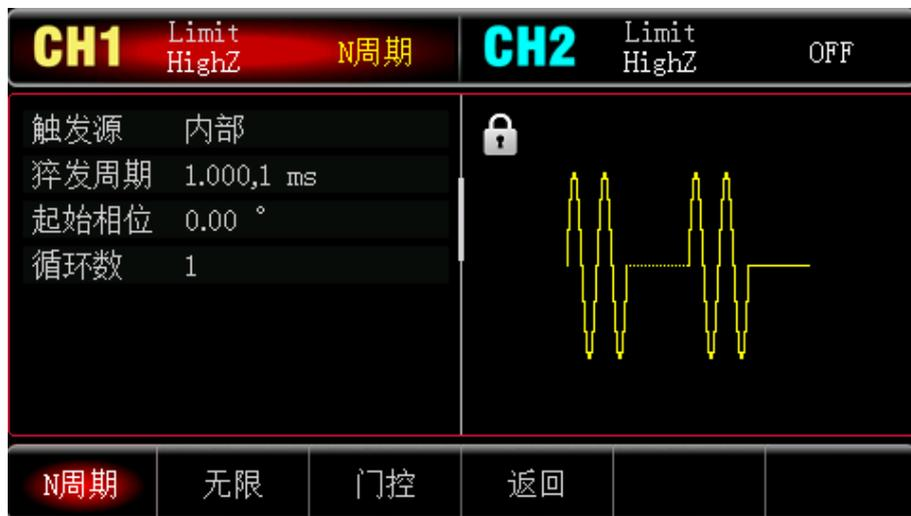
支持“N周期”“无限”和“门控”三种脉冲方式。“内部”和“外部”两种触发源。
