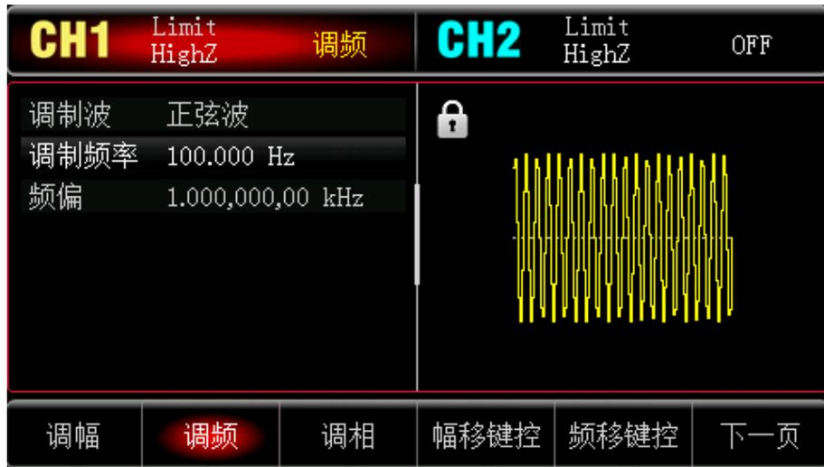
支持 AM、FM、PM、FSK、ASK、PSK 和 PWM 多种模拟和数字调制方式。
