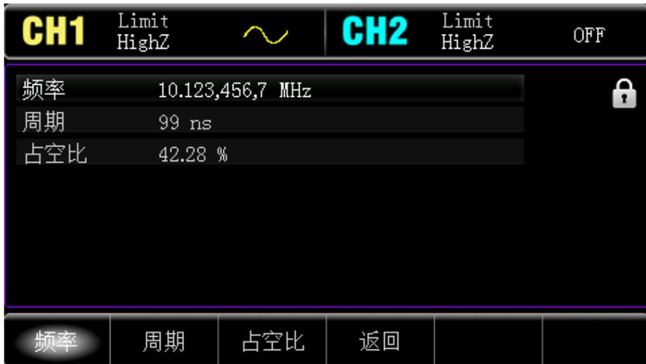
高精度频率计，可测 100mHz~200MHz 的频率范围。
