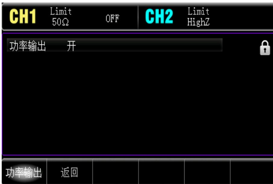
内置功率放大器的功率带宽输出高达 100kHz，最大输出功率 4W，输出摆率 Slew Rate 大于 18V/μs。
