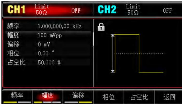
按 **频率** 软键设置频率，使用数字键盘输入 1 ，然后选择参数单位 **kHz**；
