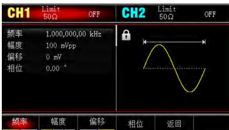
此时可以利用多功能旋钮和方向键的配合进行幅度设置（注：此处若显示为频率则只能对频率进行设置，也就是说不能实现频率与周期的转换。若显示为频率，则 2ms 的周期对应 500Hz 的频率，它们成倒数关系，即： $T=1/f$ ）。您也可以再次按 **频率** → **频率** 软键（第二次按 **频率** 软键用于对参数列表的频率与周期进行转换），此时会弹出如下界面：
