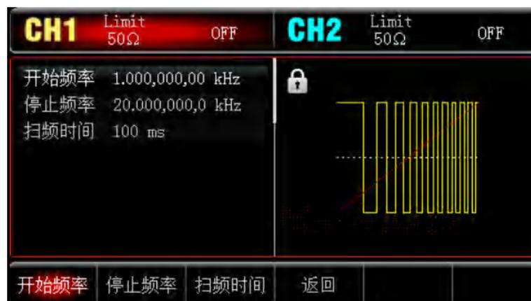
按 **开始频率** 或 **停止频率** 软键，再使用数字键盘输入 1，然后选择参数单位 **kHz**。起始频率默认为 1kHz。
