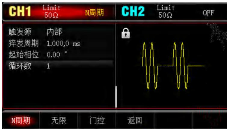
猝发周期（脉冲串周期）仅适用于N循环模式，定义为从一个脉冲串开始到下一个脉冲串开始的时间，当触发源选择为外部触发时，参数列表会隐藏猝发周期（脉冲串周期）选项。猝发周期（脉冲串周期）的可设置范围为1us~500s，默认“猝发周期”时间为1.001ms，若要进行更改在选择脉冲串的类型为N循环后利用多功能旋钮和方向键的配合或按**猝发周期**软键来完成更改。
