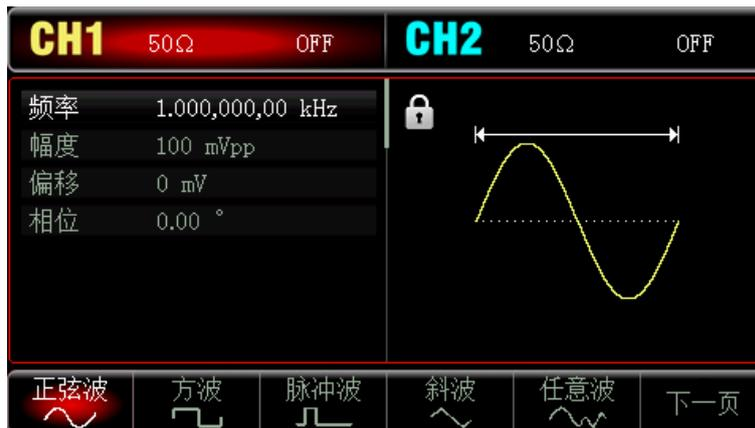
按 **幅度** 软键设置幅度，使用数字键盘输入 1，然后选择参数单位 **Vpp**；
