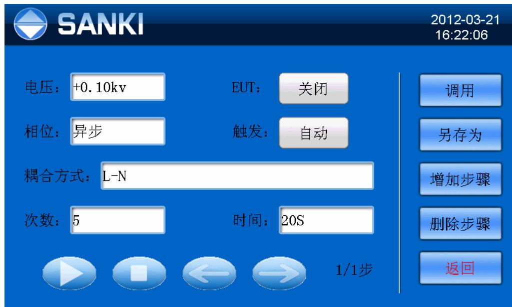
图10 雷击浪涌参数设置主界面
