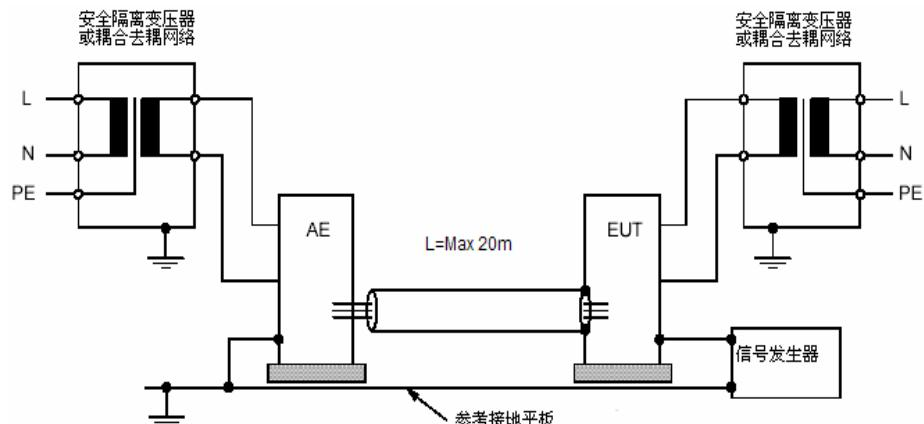
注1 允许不经过隔离变压器而通过 EUT 和/或 AE 供电, 如图 4 所示, 但此时应断开 EUT 的保护地
