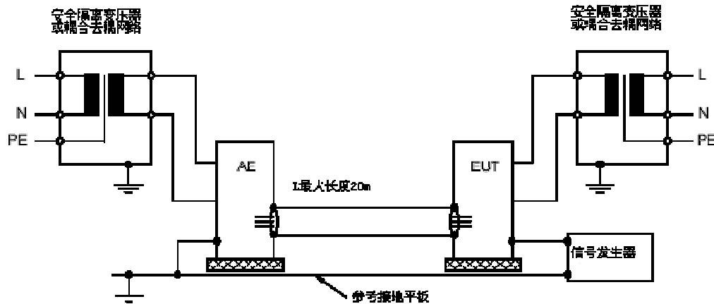
注1 允许不经过隔离变压器而通过 EUT 和/或 AE 供电, 如图 4 所示, 但此时应断开 EUT 的保护地
