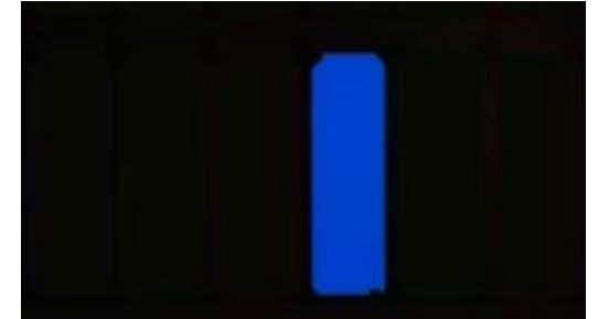
亮 Stuck Pixels 点：蓝色分像素点常亮时在暗背景上显现的常亮点。
