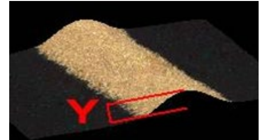
银手指：单晶硅太阳能电池表面三维重构；物镜：EC Epiplan-NEOFLUAR 20x/0.50
