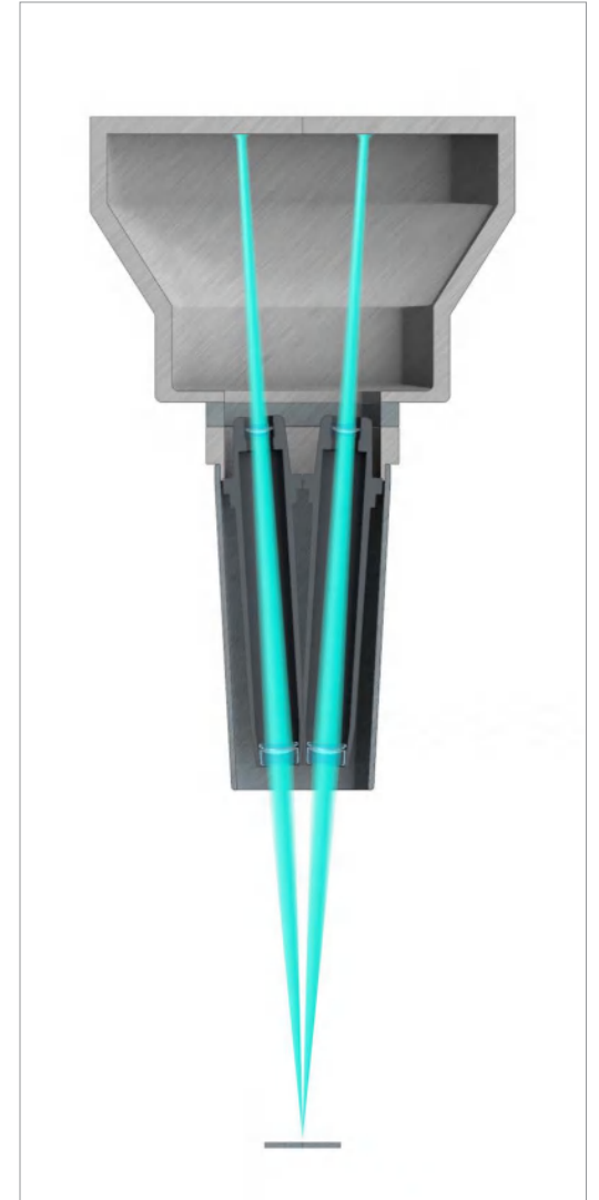
格里诺式体视显微镜的光路
