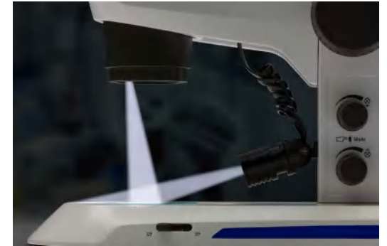
按下按钮就可轻松切换垂直照明，单点斜照明或混合光照明并调整光强
