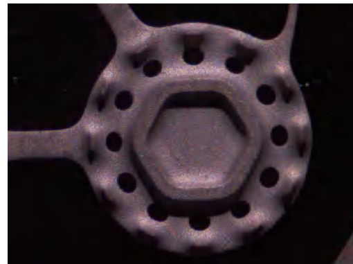
汽车零部件, K LED, 斜照明, 放大1.5x, 前端镜0.75x
