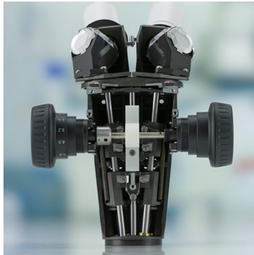
蔡司 Stemi 508 是一款拥有 8:1 大变倍比的 Greenough 光学系统，装配夹角为 11° 的双目镜筒，可以获得出色的立体图像
