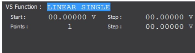
使用此子面板可将 B2985B/B2987B 中的电压源设置为扫描源或方波波形发生器。要选择源功能，请使用字段指针在 VS Function 字段上处于 EDIT (绿色) 状态时显示的辅助键。
