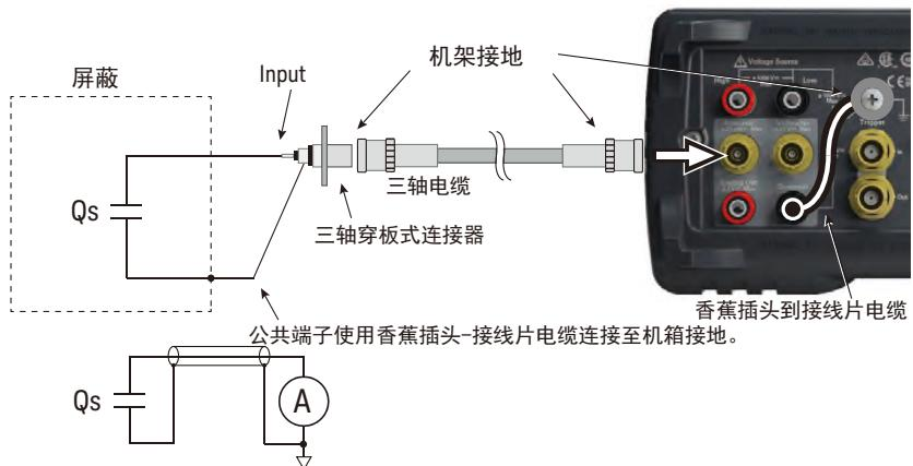
步骤 可按以下方式执行电荷测量。另请参见第 114 页上的“有关电荷测量”。
