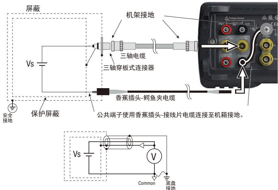
图 3-8 不带保护的电压测量连接
