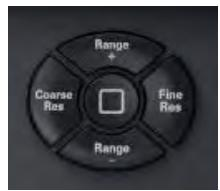
步骤 3. 使用导航键或 SPEED 功能键设置所需的测量速度（孔径时间）。有关详细信息，请参见第 82 页上的“孔径时间”。
