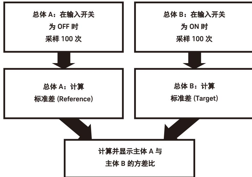
如果对这些结果执行 95 % 置信度的单边 F 检验并且计算得到的方差比小于 1.4，则输入开关为 OFF 时的总体 A (Reference) 和输入开关为 ON 时的总体 B (Target) 视为相同。这意味着包含测量环境的 Target 的噪声电平被视为与 Reference 相同。
