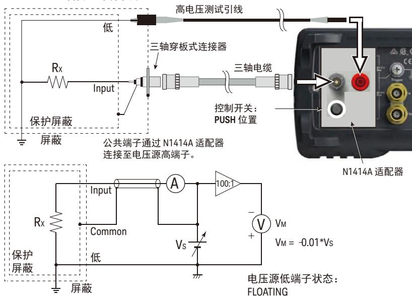
对于接地设备测量，将 N1414A 控制开关设置到 PUSH 位置。同样将电压源低端子状态设置为 FLOATING。
