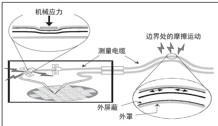
通常，使用低噪声同轴电缆可以降低振动导致的噪声。同时，固定电缆也可以有效阻止其振动。请注意，作用于电缆的应力过多或将其拉紧弯曲会对测量产生有害影响。
