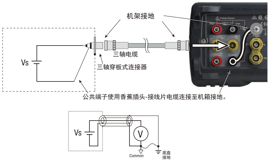
如果不想连接伏特表的内屏蔽 (Common)，可使用香蕉插头至鳄鱼夹电缆连接 Common 与被测电压的低电平端子。
