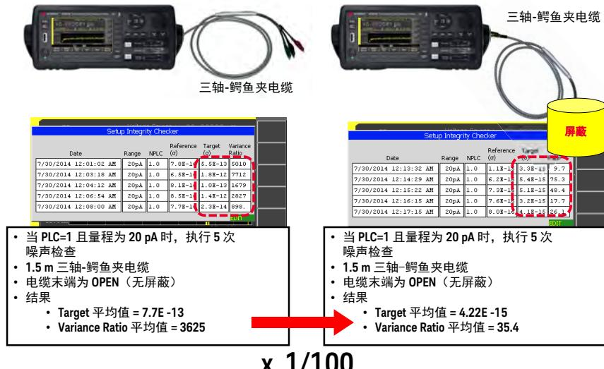
此示例将仅连接三轴 - 鳄鱼夹的情况（图中左侧）与连接与机箱连接的屏蔽箱所覆盖的三轴 - 鳄鱼夹电缆的情况（图中右侧）进行比较。在比较中，执行了 5 次噪声检查并计算了两种情况下的结果的平均值。
