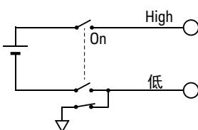
用于高达  $\pm 1050$  V 的直流电压输出的香蕉端子。
