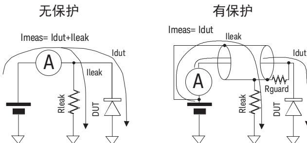
如果安培表的 Input 和其他电势之间存在电介质，则漏电流将根据电势差和电阻流动。保护技术使用与安培表的 Input 端具有相同电势的导体 (Guard) 覆盖从 Input 连接出的电线，以消除与周围电介质之间的势差，从而减小漏电流。由于
