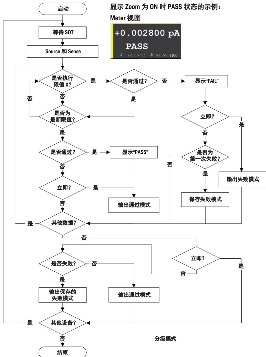
图 5-8 排序模式的限值测试流程图示例
