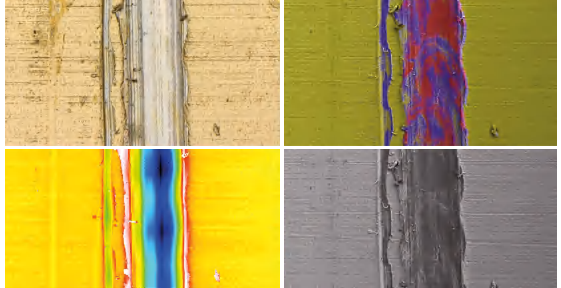
电子触点磨损痕迹的研究：光学显微镜 (LM) 宽场对比度下的景深扩展 (EDF) 图像 (左上)、扫描电子显微镜 (SEM) 能量散射 X 射线光谱 (EDS) 映射 (右上)、彩色编码高度图 (左下)、SEM 中背散射电子 (BSE) 信号 (右下)。
